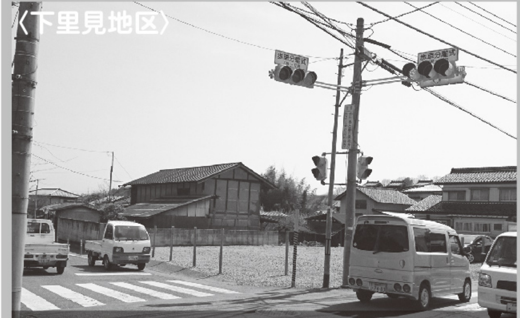
下里見小学校東側の信号機。日射と重なり見にくいとの指摘を受け、LED化。
